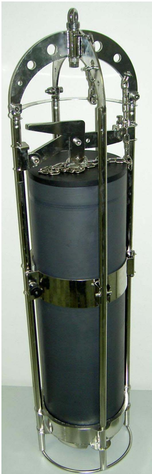
**NPA Plus** est un analyseur in situ, submersible multi paramètre pour l'analyse séquentielle automatique de 1 à 4 nutriments dans les eaux superficielles et marines.
